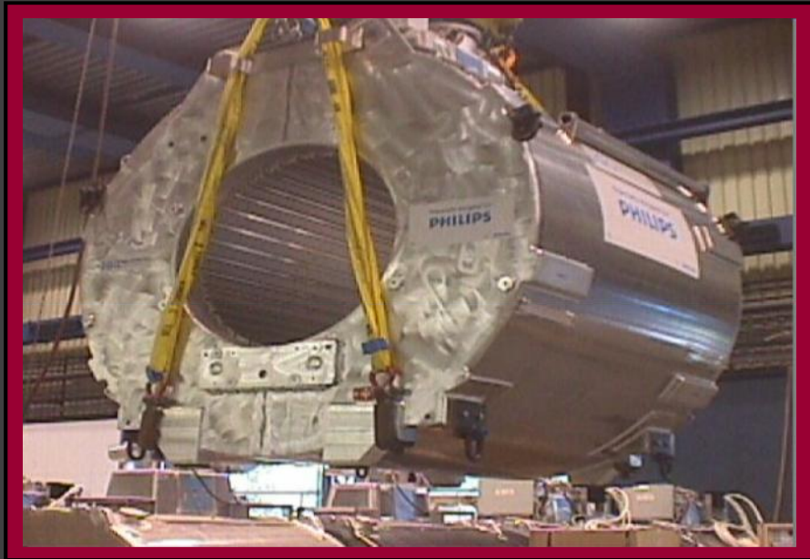
Adskilt magnet med hul til gradienterne
