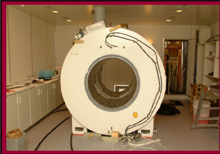
Adskilt magnet med hul til gradienterne
